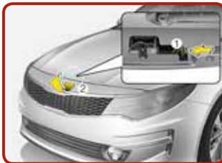
① Lyft upp huvan något. ② Tryck den sekundära spärren inåt lyft upp motorhuv
