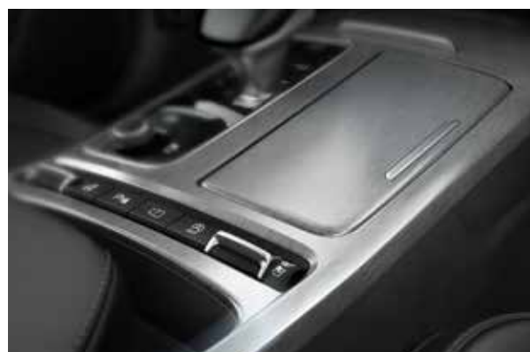
Garnissage de la surface supérieure de la console.
