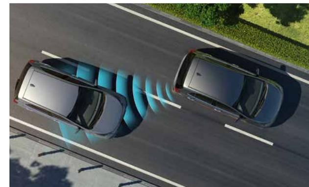
**Surveillance des angles morts (BCW) et Dispositif d'aide à l'évitement des collisions dans les angles morts (BCA)**
