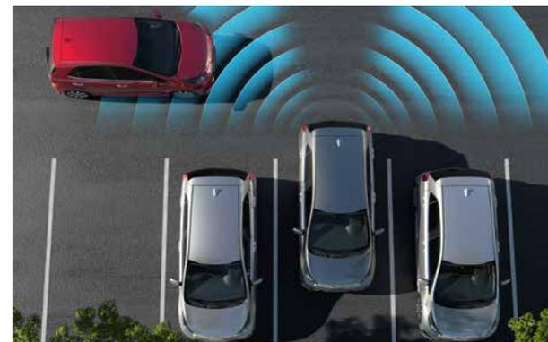
**Aide anticollision avec le trafic arrière (RCCA) et Détection de trafic arrière (RCCW)**
