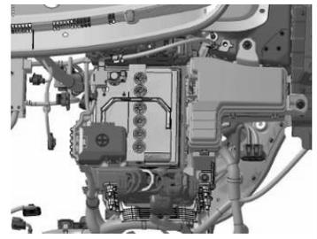
3. Die Batterie befindet sich im Motorraum.
