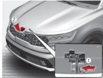
2. Motorhaube leicht anheben, Hebel in der Mitte der Motorhaube aus der halb eingerasteten Stellung hochdrücken (①) und Motorhaube anheben (②).
