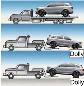
Hinweis: Die Nutzung von Radhebern oder eines Tieflader-Abschleppfahrzeugs wird empfohlen. Zum Abschleppen müssen Radheber oder ein Tieflader-Abschleppfahrzeug verwendet werden.
