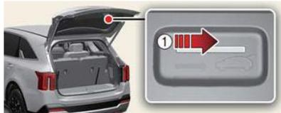
2. Den Riegel in Pfeilrichtung ① schieben, um die Heckklappe zu entriegeln.
