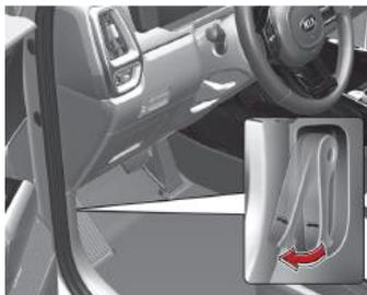
1. Entriegelungshebel betätigen, um die Motorhaube zu entriegeln. Die Motorhaube sollte sich etwas öffnen.
