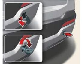
Der Abschlepphaken befindet sich in der Werkzeugbox in der Heckklappe.
