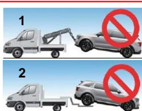
Hinweis: Nicht mit Abschleppschlingen abschleppen (1). Das Fahrzeug darf nicht abgeschleppt werden, während die Vorderräder den Boden berühren. Hierbei kann es zu Schäden am Fahrzeug kommen (2).
