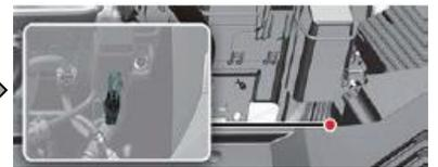
In Notfällen das Notfalltrennkabel durchtrennen, um die Hochspannungsversorgung der Batterie zu unterbrechen.
