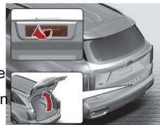
2. Bei vorhandenem Smart Key alternativ die Taste für die Heckklappe betätigen
