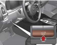
1. Taste zum Öffnen der elektrischen Heckklappe etwa eine Sekunde lang drücken
