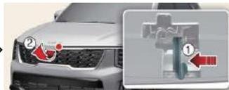
Sekundären Entriegelungshebel aus der halb eingerasteten Stellung (1) nach links drücken und Motorhaube (2) anheben.
