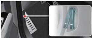
Entriegelungshebel betätigen, um die Motorhaube zu entriegeln.
