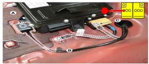
1. Minuspol (-) und Pluspol (+) der 12 V-Batterie trennen. Anschließend nacheinander das Kabel der Niedervolt-Batterie (A), das Erdungskabel (B) und das Inverterkabel (C) trennen.
