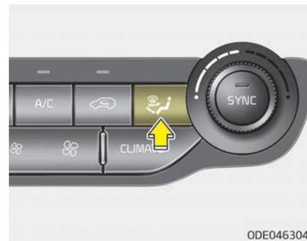
Die Modustaste steuert die Richtung des Luftstroms im Belüftungssystem. Die Lüftungsmodi werden wie folgt eingestellt:
