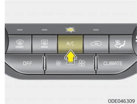
Drücken Sie die Taste A/C, um die Klimaanlage einzuschalten. Die Kontrollleuchte im Schalter leuchtet bei eingeschalteter Klimaanlage auf.
