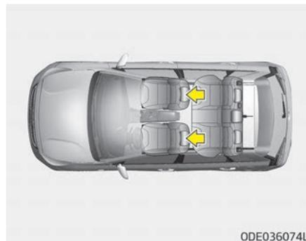
Um den Fahrzeuginsassen Sicherheit und Komfort zu gewährleisten, sind der Fahrersitz und der Beifahrersitz mit Kopfstützen ausgestattet. Die Kopfstütze bietet nicht nur Komfort für den Fahrer und die Beifahrer, sondern sie stützt auch den Kopf und den Nacken im Fall einer Kollision ab.
