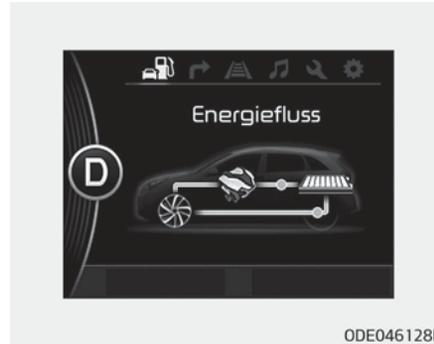
Das Fahrzeug wird durch die Motor-kompression und das regenerative Bremsen abgebremst. Die Hybrid-Batterie wird durch regeneratives Bremsen aufgeladen.
