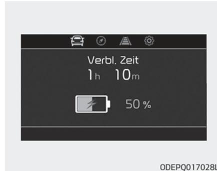
10. Nach dem Start des Ladevorgangs wird die voraussichtliche Ladezeit für 1 Minute im Kombiinstrument angezeigt. Diese Meldung wird auch angezeigt, wenn die Fahrertür während des Aufladevorgangs geöffnet wird. Wenn eine zeitabhängige Ladung eingestellt ist, wird die voraussichtliche Aufladezeit als "--" angezeigt.
