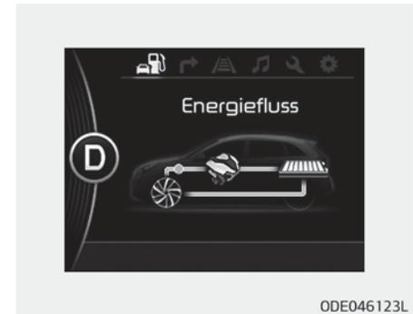
Das Fahrzeug wird mit Energie aus dem Verbrennungsmotor bewegt.
