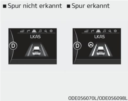
Wenn die Geschwindigkeit des Fahrzeugs über 60 km/h liegt und das System die Fahrspurmarkierung erkennt, ändert sich die Farbe von Grau in Weiß. Wenn die nachstehenden Bedingungen erfüllt sind, kann LKAS die Lenkung unterstützen.
