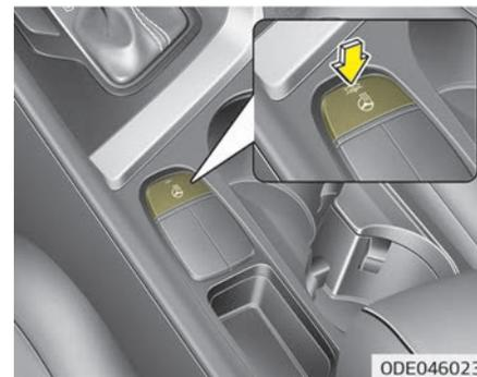
Wenn sich der Zündschlüssel in der Stellung ON bzw. der Knopf ENGINE START/STOP (Motorstart/-stopp) in der Position ON befindet, wird durch Betätigung der Taste für die Lenkradheizung das Lenkrad erwärmt. Daraufhin leuchtet die Kontrollleuchte der Taste auf.
