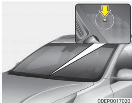
Sie können den Ladezustand außerhalb des Fahrzeugs überprüfen, wenn Sie die Hochvoltbatterie aufladen oder verwenden (nicht im Fahrmodus).
