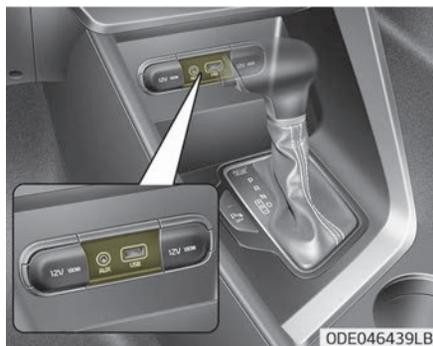
An den AUX-Anschluss können Sie Audiogeräte und an den USB-Anschluss USB-Geräte oder einen iPod® anschließen.
