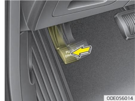
Um die Feststellbremse zu lösen, halten Sie das Pedal der Fußbremse getreten und treten Sie dabei das Pedal der Feststellbremse nieder. Das Pedal der Feststellbremse kehrt danach automatisch in seine vollständig gelöste Stellung zurück.
