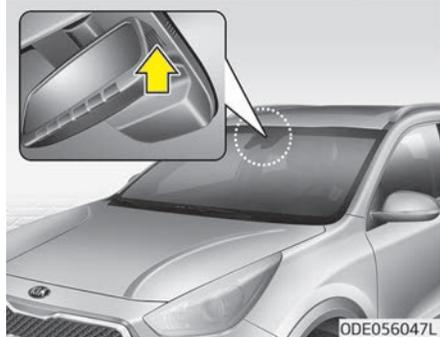
Das Spurhaltewarnsystem erkennt die Fahrspurmarkierungen auf der Straße mit einer Frontkamera in der Windschutzscheibe und unterstützt den Fahrer beim Lenken, damit das Fahrzeug in der Fahrspur bleibt. Wenn das System erkennt, dass ein Fahrzeug seine Fahrspur verlässt, warnt es den Fahrer mit optischen und akustischen Warnsignalen und lenkt zugleich leicht gegen, um zu verhindern, dass das Fahrzeug aus der Spur gerät.
