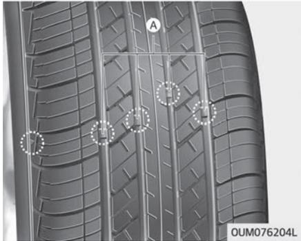
Bei gleichmäßigem Reifenverschleiß erscheint mit der Zeit eine Verschleißanzeige (A) über die Breite der Lauffläche. Sie zeigt an, dass die verbleibende Profiltiefe weniger als 1,6 mm beträgt. Ersetzen Sie den Reifen, sobald dies der Fall ist.
