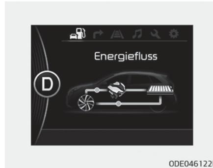
Die Motorkompression kann zum Abbremsen des Fahrzeugs genutzt werden. Das regenerative Bremssystem kann zum Aufladen des Hybridsystems genutzt werden
