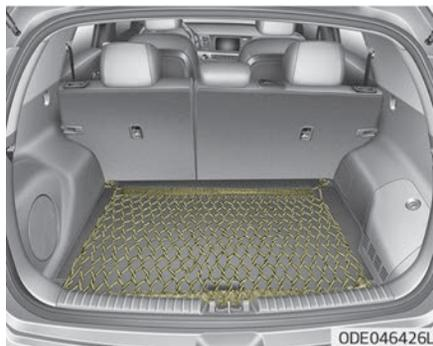
Um zu verhindern, dass sich das Ladegut unkontrolliert im Laderaum umherbewegen kann, können Sie die Halter im Laderaum für die Befestigung eines Gepäcknetzes verwenden.
