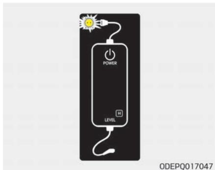
3. Stellen Sie sicher, dass die Anzeige für die Stromversorgung (grün) im Anschlusskasten aufleuchtet.
