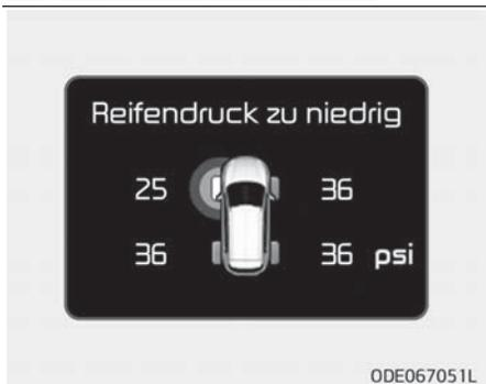
1. Positionsanzeige - Geringer Reifendruck/Kontrollleuchte für eine TPMS-Fehlfunktion
