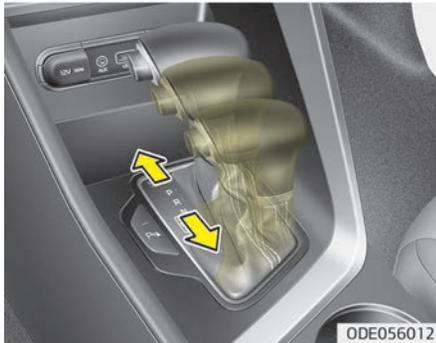
Den manuellen Modus können Sie sowohl im Stand als auch während der Fahrt wählen. Bewegen Sie dazu den Wählhebel aus der Fahrstufe (D) in die manuelle Schaltgasse. Um in die Fahrstufe (D) zurückzugelangen, bewegen Sie den Wählhebel zurück in die Automatik-Schaltgasse.
