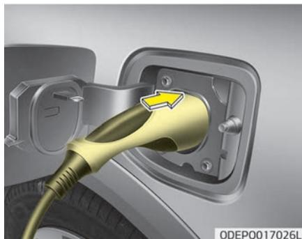
4. Entfernen Sie eventuelle Staubablagerungen von dem Aufladeverbinder und der Aufladebuchse.
