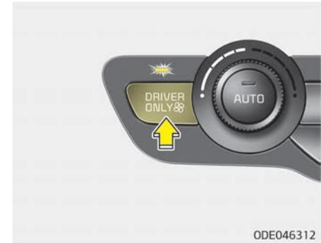
Wenn Sie die NUR-FAHRER-Taste drücken und die Kontrollleuchte aufleuchtet, wird kalte Luft vorrangig in Richtung des Fahrersitzes geblasen. Ein Teil der kalten Luft tritt jedoch auch aus den Kanälen der anderen Sitze aus, um eine komfortable Lüftung des Innenraums zu gewährleisten. Wenn Sie die Taste drücken und sich keine Person auf dem Beifahrersitz befindet, wird der Energieverbrauch reduziert.
