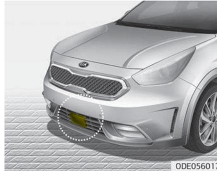
Der Sensor dient zur Einhaltung eines bestimmten Abstands zum vorausfahrenden Fahrzeug. Verschmutzungen auf dem Sensorobjektiv, zum Beispiel Schnee oder Regen, beeinträchtigen jedoch die Erkennungsleistung und können sogar zu einer vorübergehenden Deaktivierung der AEB-Funktion führen. Halten Sie die Sensorlinse immer sauber.
