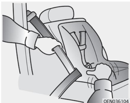
Um das Kinderrückhaltesystem zu entfernen, drücken Sie die Entriegelungstaste an der Gurtschnalle, ziehen Sie den Dreipunktgurt aus dem Kinderrückhaltesystem heraus und rollen Sie den Sicherheitsgurt vollständig auf.
