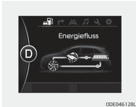
Der Verbrennungsmotor und das regenerative Bremssystem laden die Hybrid-Batterie beim Abbremsen auf.
