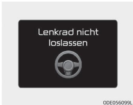
Wenn der Fahrer das Lenkrad mehrere Sekunden lang loslässt, während das LKAS aktiviert ist, warnt das System den Fahrer.
