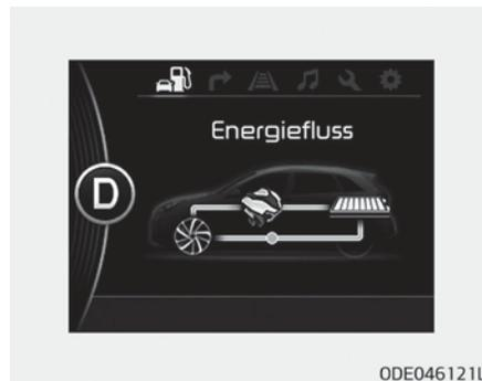
Das Fahrzeug wird mit elektrischer Energie bewegt.
