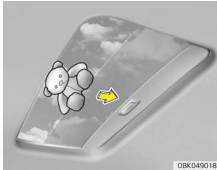
Wenn beim automatischen Schließen des Schiebedachs oder Gegenstand oder Körperteil erkannt wird, fährt das Schiebedach oder Sonnenschutz zurück und bleibt danach stehen.
