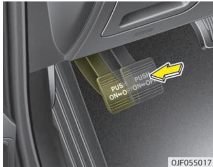
Prüfen Sie, ob der Hub den Vorgaben entspricht, wenn das Bremspedal mit einer Kraft von 30 kg (66 lb, 294 N) gedrückt wird. Die Feststellbremse alleine sollte außerdem das Fahrzeug an einer relativ steilen Neigung sichern. Wenn der Hub größer oder kleiner als vorgegeben ist, lassen Sie die Anlage von einer Fachwerkstatt überprüfen. Kia empfiehlt den Besuch eines Kia-Händlers/Servicepartners.
