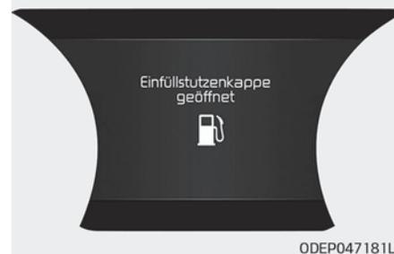
Warten Sie, bis die Druckentlastung des Kraftstofftanks abgeschlossen ist. Diese Meldung wird angezeigt, wenn die Tankklappe sich nach der Druckentlastung des Kraftstofftanks öffnet.
