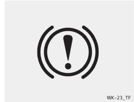
Prüfen Sie, ob die Bremswarnleuchte leuchtet, indem Sie den Knopf ENGINE START/STOP (Motorstart/-stopp) in Stellung ON bringen (lassen Sie nicht den Motor an). Die Leuchte wird eingeschaltet, wenn der Knopf ENGINE START/STOP (Motorstart/-stopp) bei betätigter Feststellbremse in die Stellung ON oder START gedreht wird. Stellen Sie vor Fahrtantritt sicher, dass die Feststellbremse vollständig gelöst und die Bremsenwarnleuchte erloschen ist.
