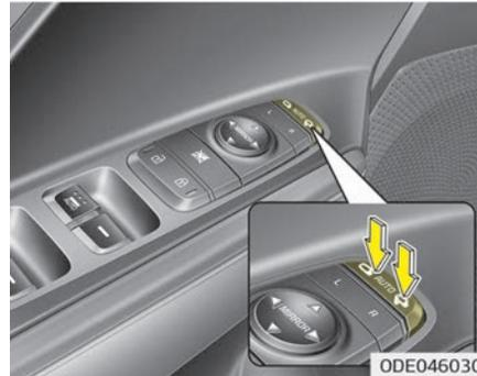
Der Außenspiegel kann mit dem Schalter, wie im Folgenden beschrieben, eingeklappt oder ausgeklappt werden.
