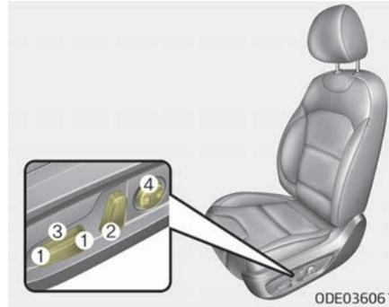
Der Vordersitz kann über die Steuer-tasten außen am Sitzkissen verstellt werden. Stellen Sie den Sitz vor der Fahrt auf die entsprechende Position ein, damit Sie das Lenkrad, die Pedale und Schalter auf der Instrumententafel gut erreichen können.
