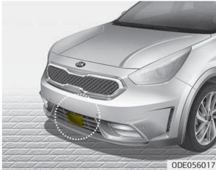
Der Sensor erkennt den Abstand zum Fahrzeug in Fahrtrichtung.
