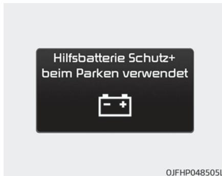
Diese Meldung erscheint, wenn die Hilfsbatterie-Sparfunktion+ bei eingeschaltetem Fahrzeug abgeschlossen ist.
