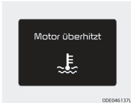
Diese Warnmeldung erscheint, wenn die Temperatur des Motorkühlmittels 120 °C übersteigt. Dies bedeutet, dass der Motor überhitzt ist und beschädigt werden könnte.
