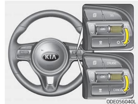
3. Drücken Sie den Hebel nach unten (in Richtung SET-) und lassen Sie ihn bei Erreichen der gewünschten Geschwindigkeit los. Die eingestell-
