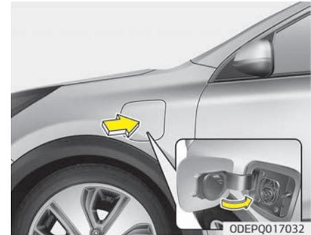
3. Achten Sie darauf, dass Sie die Aufladeklappe sicher schließen.
