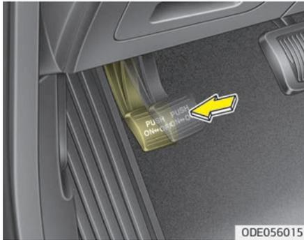
Um die Feststellbremse anzuziehen, treten Sie zuerst die Fußbremse und danach das Pedal der Feststellbremse so weit wie möglich.
