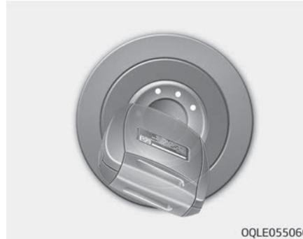
Das Lenkradschloss wird in dieser Stellung verriegelt (Diebstahlschutz). Der Zündschlüssel kann nur in der Stellung LOCK abgezogen werden.
