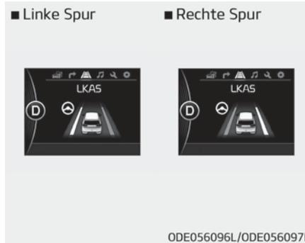
Wenn das Fahrzeug die Fahrspur verlässt, blinkt die Fahrspurmarkierung, die Sie überfahren, auf dem LCD-Display.
