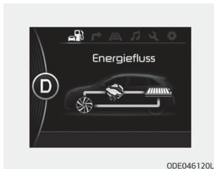
Dieser Modus bedeutet, dass das Fahrzeug angehalten hat.
