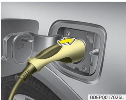
7. Erfassen Sie den Aufladeverbinder am Griff. Führen Sie den Verbinder dann in die Aufladebuchse ein, bis er hörbar einrastet. Wenn der Verbinder nicht richtig eingeführt wurde, stellt der schlechte Kontakt zwischen dem Aufladeverbinder und den Aufladeklemmen eine Brandgefahr dar.
