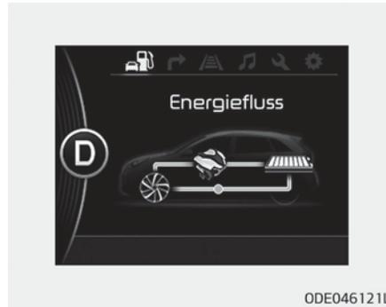
Die Hybrid-Batterie wird durch regeneratives Bremsen aufgeladen.
