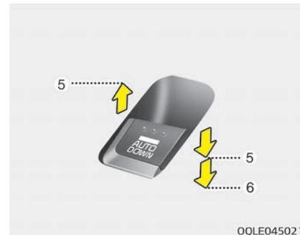
Wenn Sie die Schaltertaste kurzzeitig bis in die zweite Rastung (6) niederdrücken, öffnet sich das Fenster der Fahrertür vollständig, auch wenn Sie den Schalter wieder loslassen. Wenn Sie die automatische Fensterbewegung in einer bestimmten Position stoppen möchten, ziehen Sie den Schalter kurzzeitig in die entgegengesetzte Richtung der Fensterbewegung.
