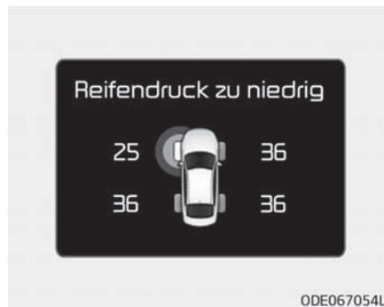
Dieser Modus zeigt den Luftdruckstatus für jeden Reifen an. Sie können die Reifendruckeinheit im Modus „User settings“ (Benutzereinstellungen) ändern.
