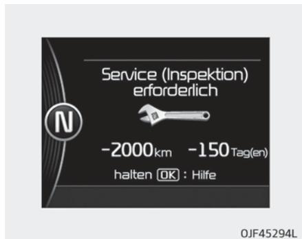
Wenn Sie in dem bereits eingegebenen Serviceintervall Ihr Fahrzeug nicht in die Werkstatt gebracht haben, wird die Meldung "Service erforderlich" immer mehrere Sekunden lang angezeigt, wenn Sie den Zündschalter oder den Knopf ENGINE START/STOP (Motorstart/-stopp) drücken.
