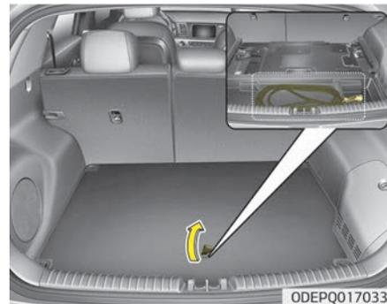
Wir empfehlen, dass Sie das Erhaltungsladekabel nach der Verwendung in eine Aufbewahrungsbox legen.
