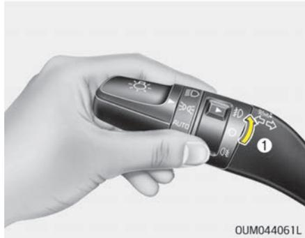
Die Nebelscheinwerfer sollen die Sicht bei schlechten Sichtbedingungen, beispielsweise Nebel, Regen oder Schnee verbessern. Die Nebelscheinwerfer werden eingeschaltet, wenn der Nebelscheinwerferschalter (1) nach dem Einschalten des Standlichts in die Stellung EIN gedreht wird.
