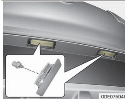
1. Hebeln Sie die Streuscheibe vorsichtig mit einem flachen Schraubendreher vom Gehäuse der Leuchte ab.
