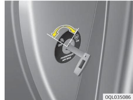
Wenn ein Kinderrückhaltesystem auf dem Beifahrersitz installiert ist oder wenn dieser Sitz nicht besetzt ist, kann der Beifahrerairbag mit dem Schalter "Beifahrer-Frontairbag ON/OFF" deaktiviert werden.
