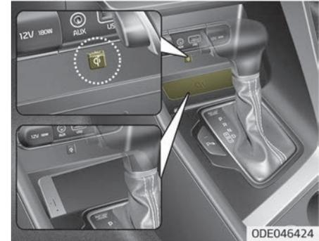
Vor der Mittelkonsole befindet sich ein Drahtlos-Ladesystem für Mobiltelefone.
