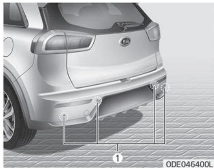
Der hintere Parkassistent unterstützt den Fahrer beim Rückwärtsfahren, indem das System einen Warnton gibt, wenn es innerhalb einer Distanz von 120 cm hinter dem Fahrzeug ein Hindernis erkennt.
