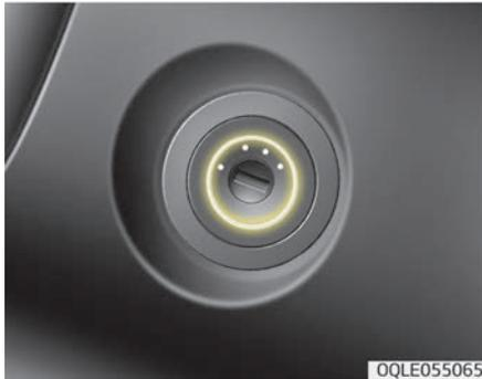
Wenn beim Öffnen der Fahrer- oder Beifahrertür die Zündung nicht eingeschaltet ist, wird die Zündschlossbeleuchtung automatisch eingeschaltet. Diese Beleuchtung erlischt ca. 30 Sekunden nach dem Schließen der Tür oder sofort, wenn die Zündung eingeschaltet wird.
