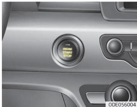
Wenn die vordere Tür geöffnet wird, leuchtet den Knopf ENGINE START/STOP (Motorstart/-stopp) auf. Das Licht erlischt nach etwa 30 Sekunden, nachdem die Tür geschlossen wurde. Sie erlischt sofort, wenn der Knopf ENGINE START/STOP (Motorstartknopf) in die Stellung ON gedrückt wird.
