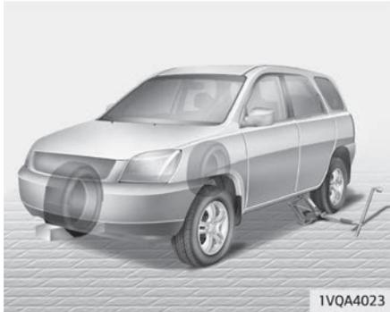
4. Nehmen Sie den Radmutter Schlüssel, den Wagenheber, die Wagenheberkurbel und das Ersatzrad aus dem Fahrzeug.
