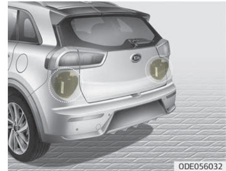
Die Sensoren befinden sich im hinteren Stoßfänger.
