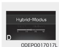
: Der Hochspannungsakku (Hybrid) und der Benzinmotor werden zum Antrieb des Fahrzeugs verwendet.
