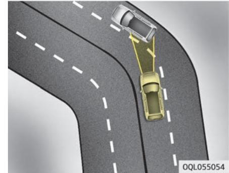
In Kurven erkennt das AEB möglicherweise ein vorausfahrendes Fahrzeug in einer Nebenspur. Fahren Sie besonders vorsichtig, und betätigen Sie bei Bedarf das Bremspedal. Drücken Sie bei Bedarf das Gaspedal, um die Fahrgeschwindigkeit beizubehalten. Überprüfen Sie zu Ihrer eigenen Sicherheit immer das Verkehrsgeschehen um Ihr Fahrzeug herum.
