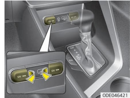
Die 12-V-Steckdosen sind für die Stromversorgung von Mobiltelefonen und anderen Geräten, die mit der Bordspannung des Fahrzeugs betrieben werden können, vorgesehen. Die Geräte sollten bei laufendem Motor weniger als 10 A verbrauchen.
