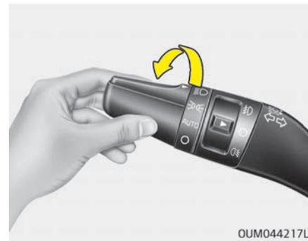
In der Schalterstellung "Scheinwerfer" (4. Stufe) sind die Scheinwerfer, das Standlicht, das Rücklicht, die Kennzeichenbeleuchtung und die Armaturenbeleuchtung eingeschaltet.
