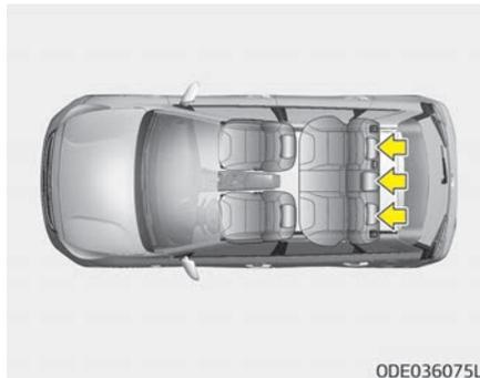
Um den Fahrzeuginsassen Sicherheit und Komfort zu gewährleisten, ist der Rücksitz mit Kopfstützen ausgestattet. Die Kopfstütze bietet nicht nur Komfort für Fahrer und Beifahrer, sondern sie stützt auch den Kopf und den Nacken im Fall einer Kollision ab.
