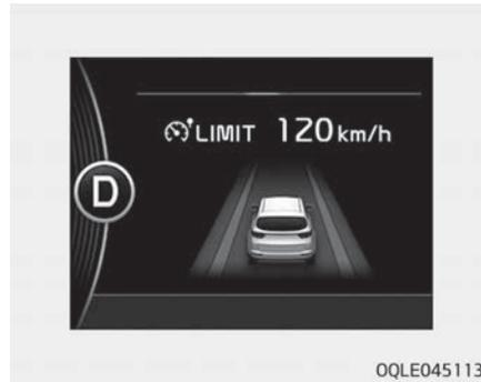
Die eingestellte Geschwindigkeitsbegrenzung wird angezeigt. Um über die voreingestellte Geschwindigkeitsbegrenzung zu fahren, müssen Sie das Gaspedal stärker betätigen (mehr als ca. 80 %), bis der Kick-down-Mechanismus durch ein Klickgeräusch aktiviert wird. Dann blinkt die eingestellte Höchstgeschwindigkeit und es ertönt ein Warnsignal, bis Sie wieder auf eine Geschwindigkeit unter der Höchstgeschwindigkeit zurückkehren.
