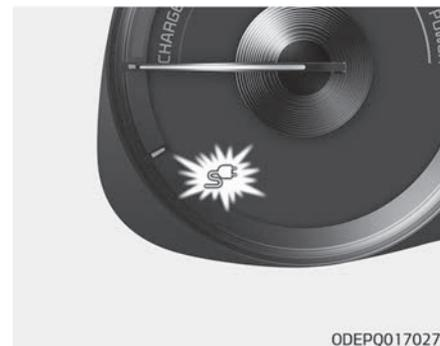
6. Überprüfen Sie, ob die Kontrollleuchte für den Anschluss des Aufladekabels der Hochvoltbatterie im Kombiinstrument leuchtet. Der Aufladevorgang beginnt nur, wenn die Kontrollleuchte leuchtet. Wenn der Aufladeverbinder nicht richtig angeschlossen ist, schließen Sie das Aufladekabel zur Aufladung erneut an.
