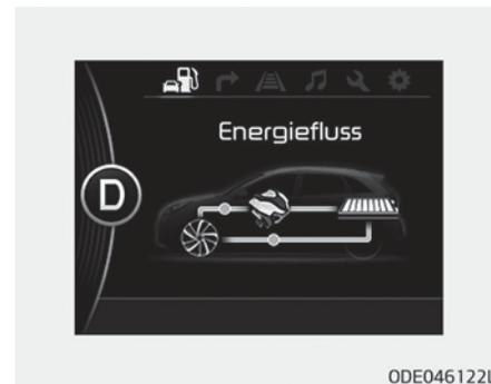
Das Fahrzeug wird mit Energie aus dem Verbrennungs- und dem Elektromotor bewegt.
