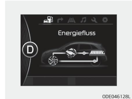
Der Verbrennungsmotor und das regenerative Bremsssystem laden die Hybrid-Batterie beim Abbremsen auf.
