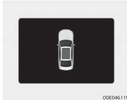
Wenn der Fahrer den Zündschlüssel abzieht (Smart-Key: den Motor ausschaltet) und das Schiebedach nicht voll geschlossen ist, ertönt etwa 6 Sekunden lang ein Warnton, und es erscheint eine Warnmeldung auf dem LCD-Display. Schließen Sie das Schiebedach sicher, wenn Sie Ihr Fahrzeug verlassen.
