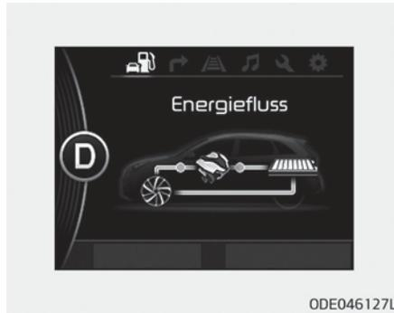
Der Verbrennungsmotor treibt das Fahrzeug an und lädt die Hybrid-Batterie auf.
