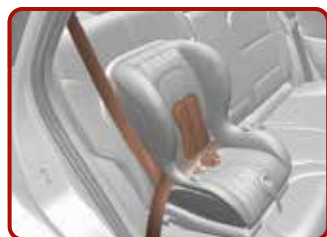
Ein Kinderrückhaltesystem mit einem Dreipunktgurt befestigen [4]
